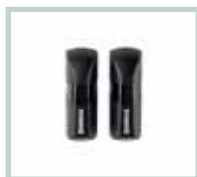
PUPILLA Paire de photocellules orientables à 180°. Possibilité de synchronisation jusqu'à 4 paires, alimentation 24 Vdc. Facilité de réglage à l'aide d'un LED qui signale l'alignement optimal. Très compact : 36x110x35 mm
